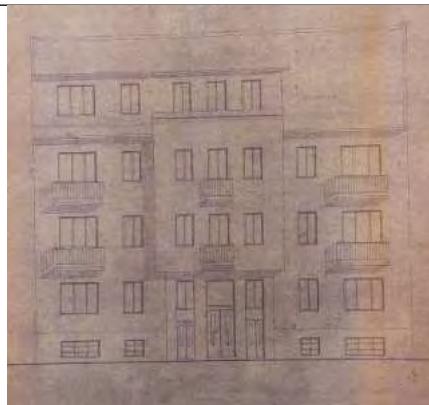
Homlokzat tetőemelet ráépítéssel (1956)
