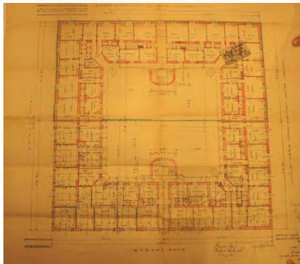
Földszint (az alaprajzon jól látszik a tükörképként tervezett, de végül meg nem valósult bérház)
